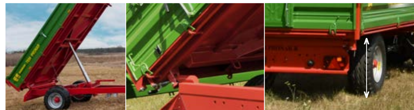
Système de bennage sur 3-côtés avec vérin télescopique avec une suspension articulée
