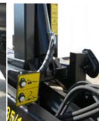
Réglage automatique de fonction bennage/basculement
