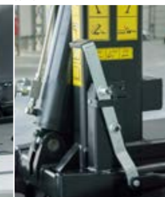
Réglage manuel de fonction basculement/benne
