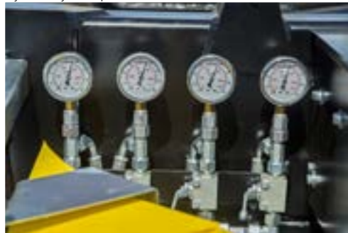
Système hydraulique d'essieu suiveur directionnel
