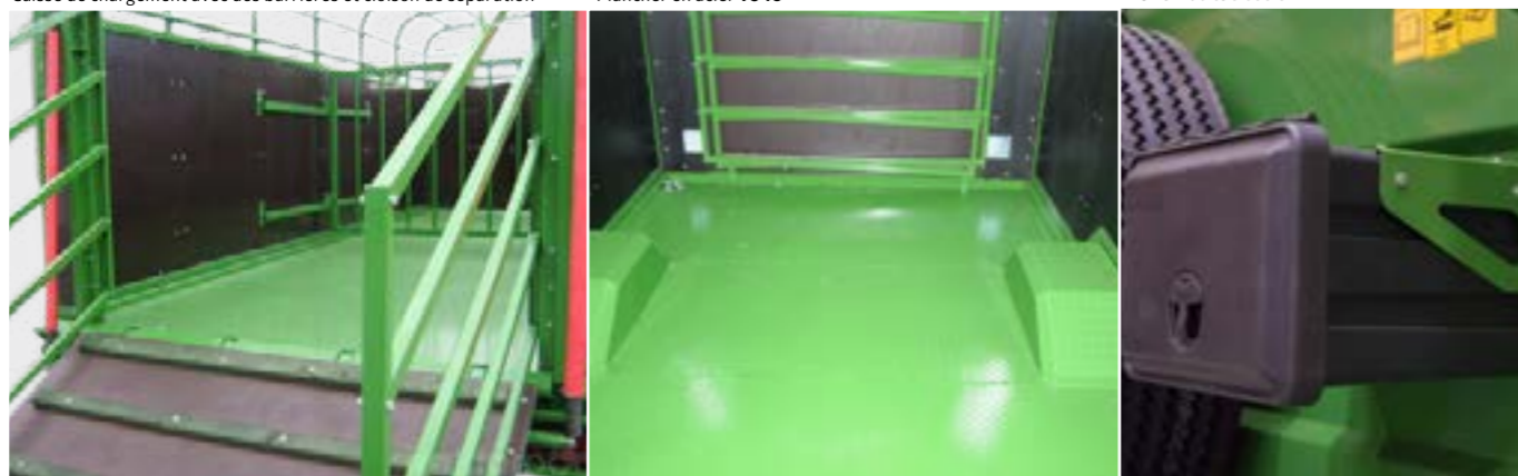
Caisse de chargement avec des barrières et cloison de séparation
